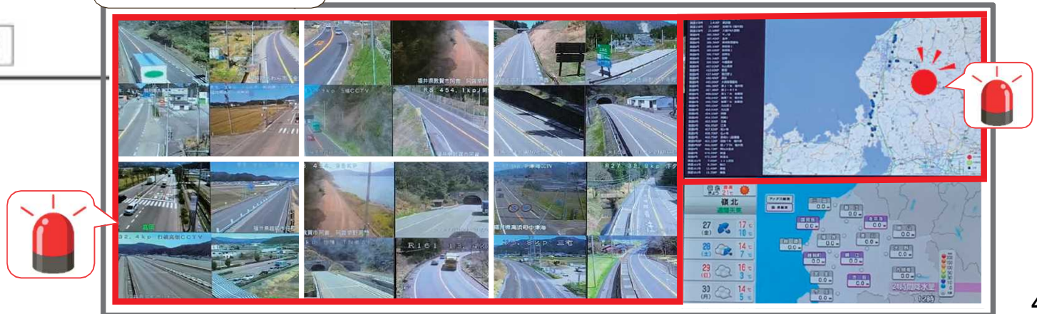
発報画面 道路情報連絡室の大型モニターに異常検知が発報
